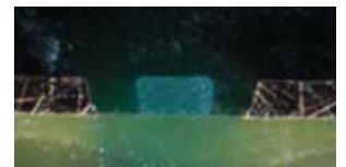
100μmソルダーダム、40μm厚ソルダーマスク
